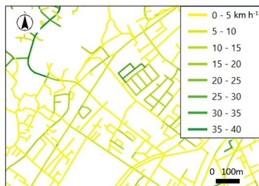
図-3 下水人孔浮上による道路通行阻害リスクを考慮した通行可能最高速度
