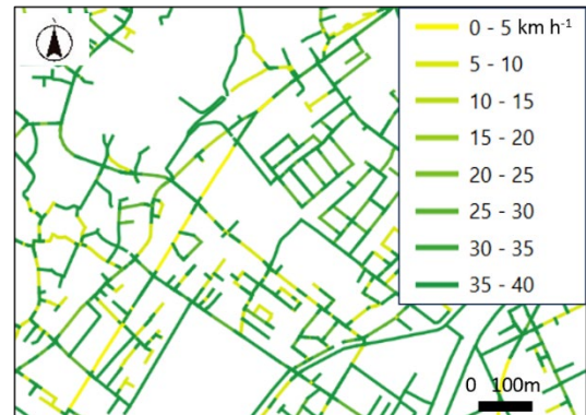
図一 水道管被害による道路通行阻害リスクを考慮した通行可能最高速度
