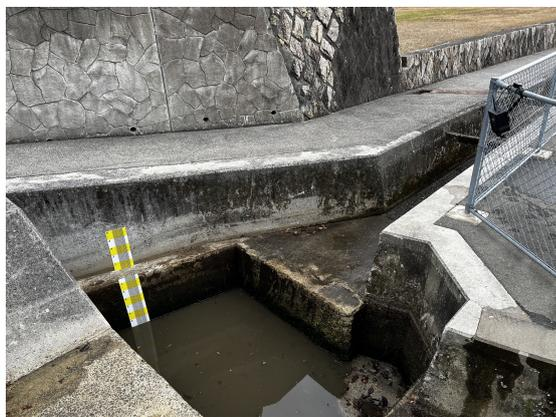
図-2 観測場所の状況（水位スケールとカメラ）
