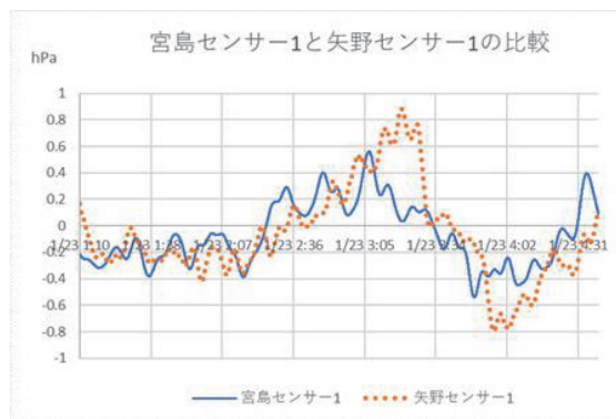
図-4 宮島包ヶ浦と広島市安芸区矢野で観測された気圧微変動の時系列
