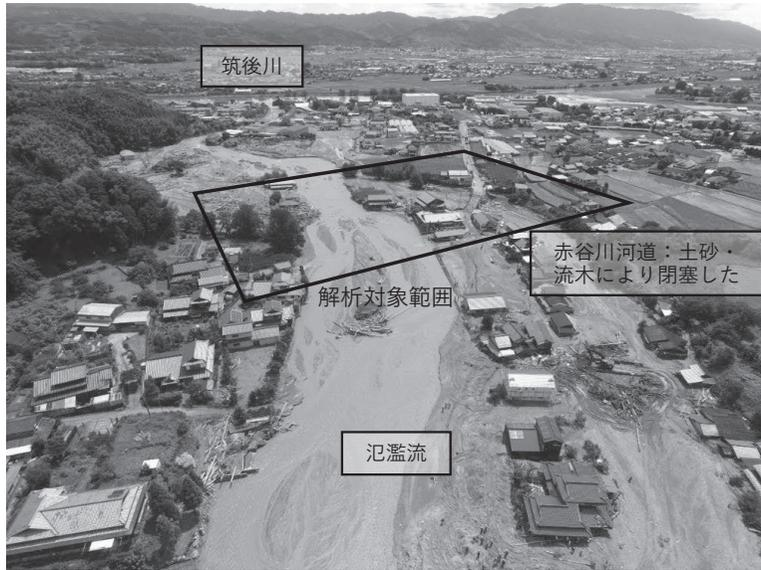
図-2 赤谷川下流域林田地区の被災状況（7月9日撮影）
